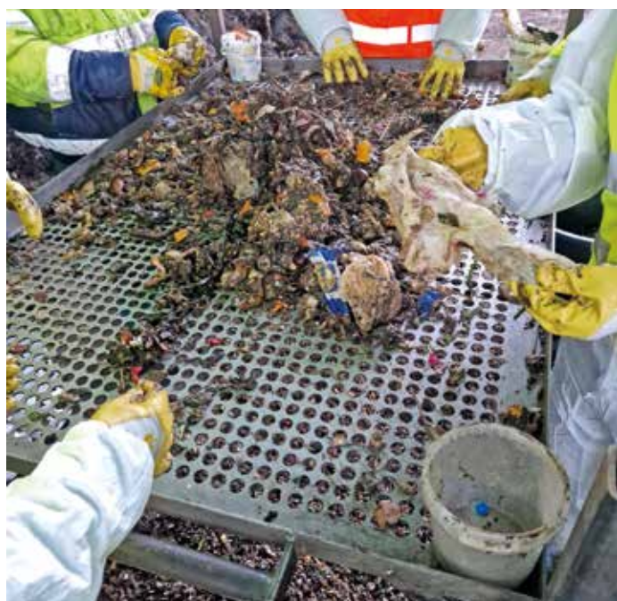
Am Sortiertisch werden Fremdstoffe und reines Biogut getrennt.
